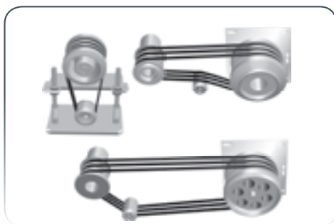
3 Keilriemenantriebe 3 verschiedene Sätze von je 3 Riemen 2 Riemenscheiben / 1 Spannelement
