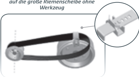
Montage mit Aufziehen des Riemens auf die große Riemenscheibe mit einem SNAP ON-Werkzeug
